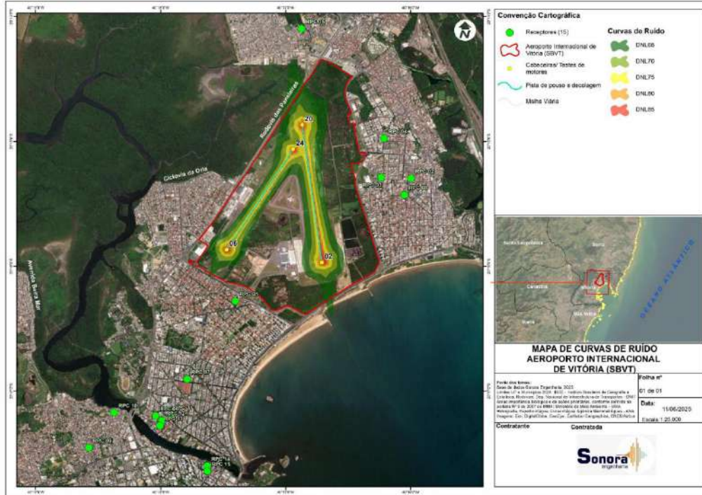
Figura 5. Curvas de ruído simuladas e os receptores potencialmente críticos
